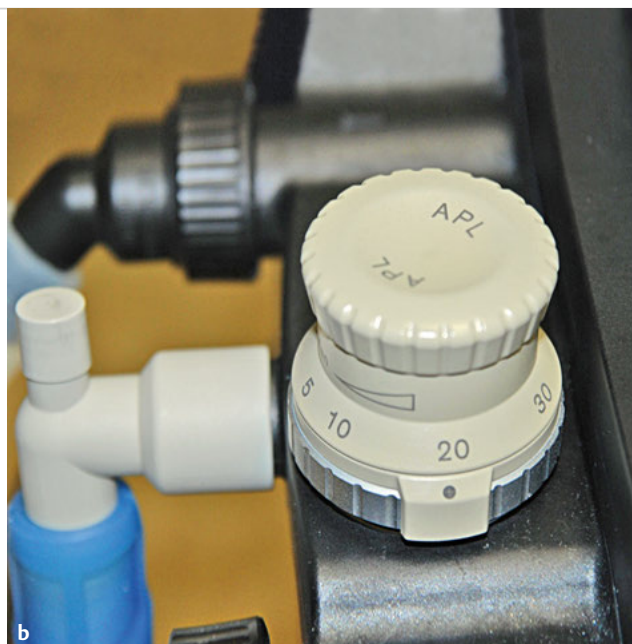
Abb. 4.41 APL-Ventil. Druckbegrenzungsventil, wie es in modernen bzw. hochmodernen Narkosegeräten (z. B. Fabius, Primus bzw. Perseus, Zeus; Fa. Dräger, Lübeck) eingebaut ist.
