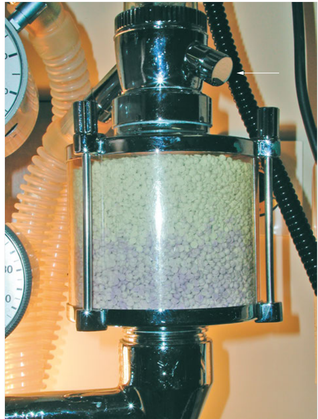
Abb. 4.39 CO 2 -Absorber mit teilweise erschöpftem (violett verfärbtem) Absorberkalk. ← zugeschraubter Anschlussstutzen, an dem alternativ die Frischgasleitung konnektiert werden könnte; vgl. ► Abb. 4.25a
