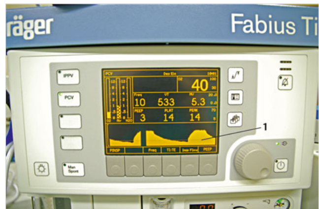
Abb. 4.38 Display für das integrierte Atemwegs-Monitoring des modernen Narkosegerätes Fabius. Dargestellt werden u.a. Atemwegsdruck (1), Atemfrequenz (Freq: 10) sowie Atemhubvolumen (VT: 533) und Atemminutenvolumen (MV: 5,3) (Fa. Dräger; vgl. ► Abb. 4.44a).
